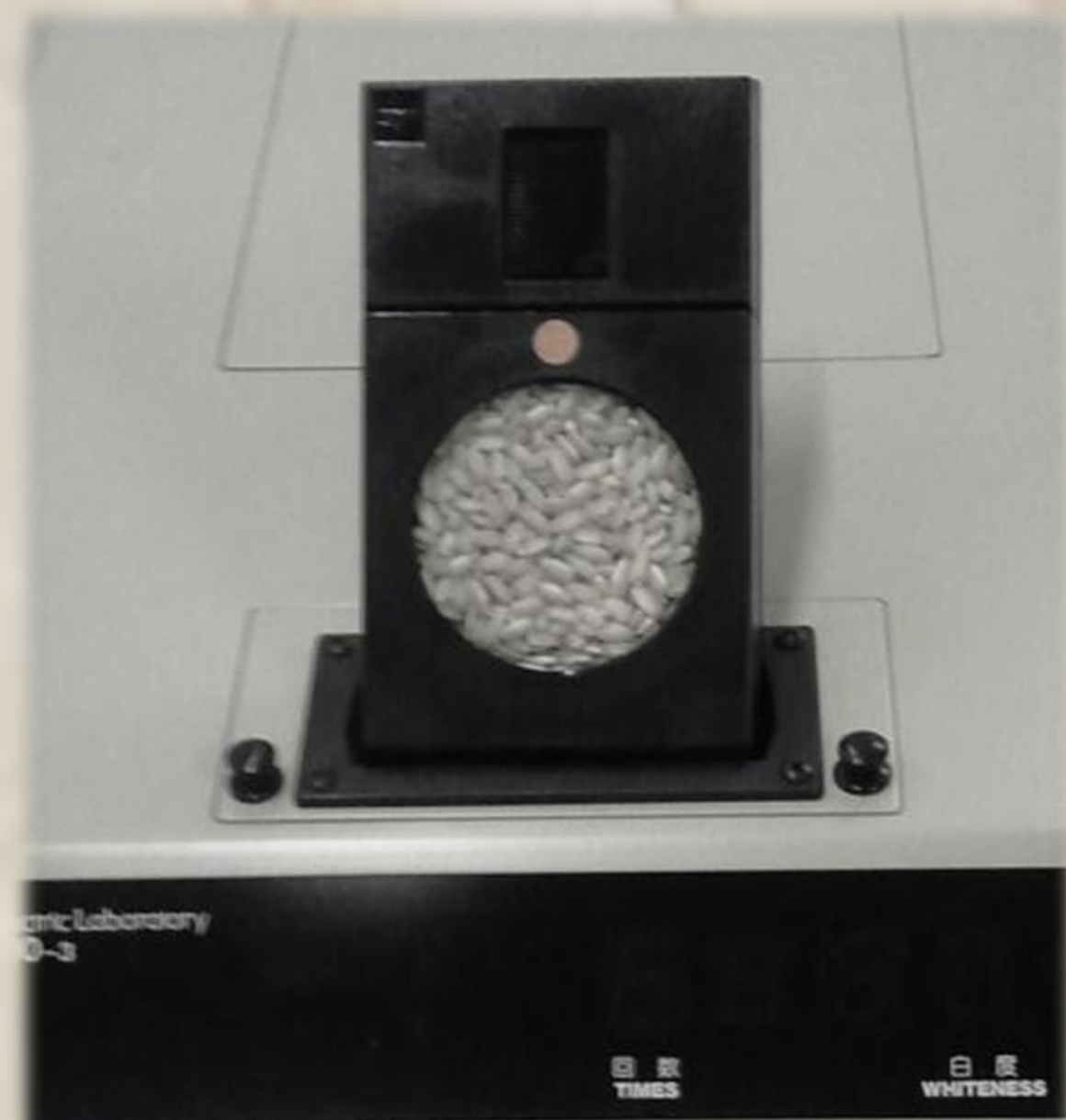
Figura 1 – in senso orario: resatrice Universale (presso Ufficio di Mortara); colorimetro KETT (dettaglio portacampione); estrattore Soxhlet (presso Laboratorio Chimico Merceologico)
